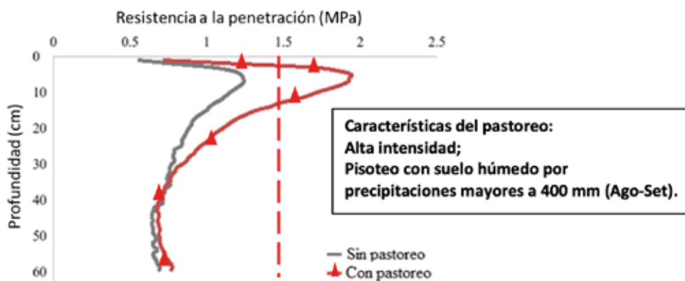
Figura 15. Efecto del pastoreo del cultivo de servicio sobre la resistencia a la penetración del suelo (0-60 cm) 9 días post siembra de soja. Línea punteada indica valores críticos de resistencia a la penetración por encima de los cuales se limita el crecimiento de las raíces de soja. Correa y Zaavedra, 2017.
